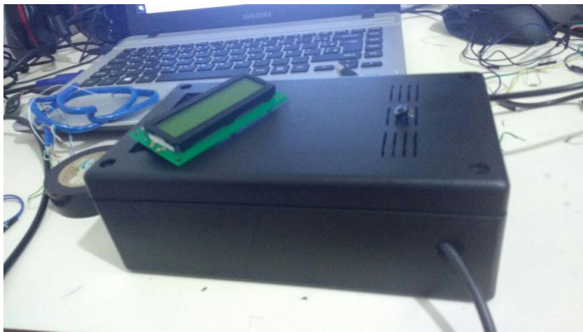
FIGURA 13 – Caixa patola com o push button instalado
