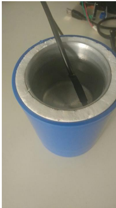
FIGURA 11 – Verificação da temperatura da água, utilizando o sensor de temperatura DS18B20
