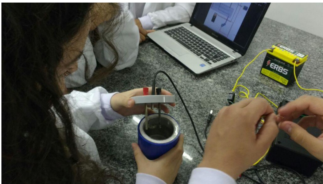
FIGURA 30 - Equipe verificando o resistor antes de fazer a ligação com a bateria.
