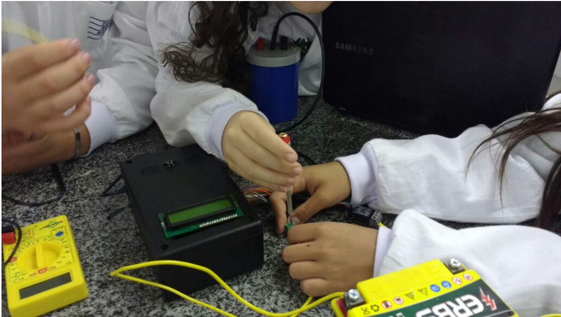
FIGURA 31 - Equipe ajustando o relé na plataforma
