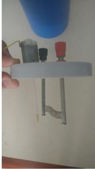
FIGURA 14 – Motor adaptado na tampa do calorímetro
